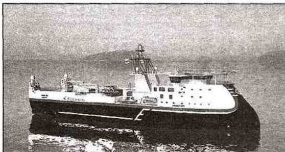
L'étrave inversée d'Ulstein apporte de réels avantages aux navires sismiques.
