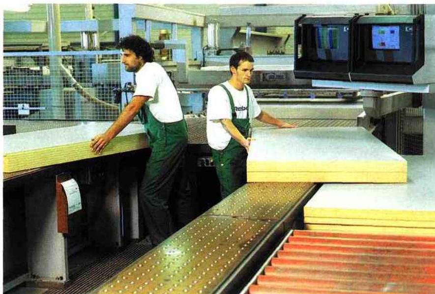
L'organisation en flux tendus, avec un en-cours de l'ordre de 2 à 4 heures entre chaque poste, amène d'énormes contraintes au niveau de la maintenance : "L'objectif zéro panne s'applique à tous les éléments sensibles comme la calandreuse, les débitieuses ou les chaînes d'usinage".
