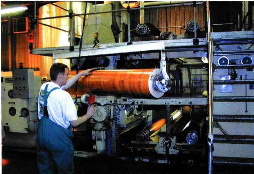
Véritable goulot d'étranglement, la chaîne de calendrage (qui dépose les papiers décors sur les panneaux), alimente les trois sites de production en flux tendu. Elle nécessite beaucoup de préventif : freins de bobines, roulements, rouleaux d'encolleuse...
